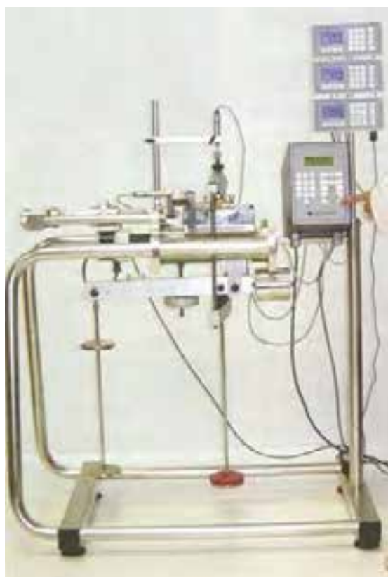
Foto 2.5.5.1 – Apparecchiatura per prove di taglio
