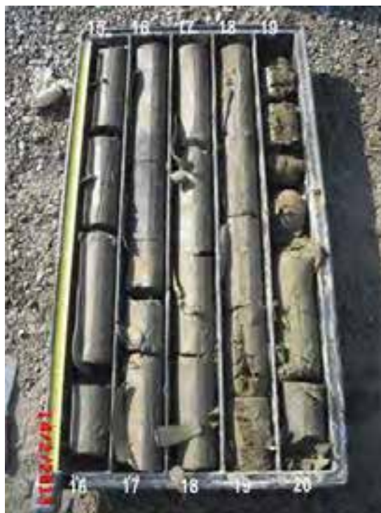
Località - Cavezzo (MO) - Ponte Molle - via Cavou, 338a Sito - 1482003 Sondaggio 1 Cassetta 4 (-13.00 m - -20.00 m da p.c.)
