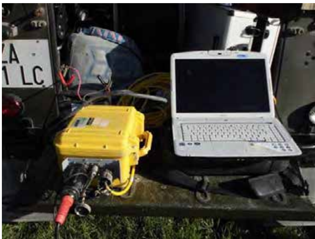
Foto 4.2.1- Apparecchiatura di registrazione per le indagini sismiche
