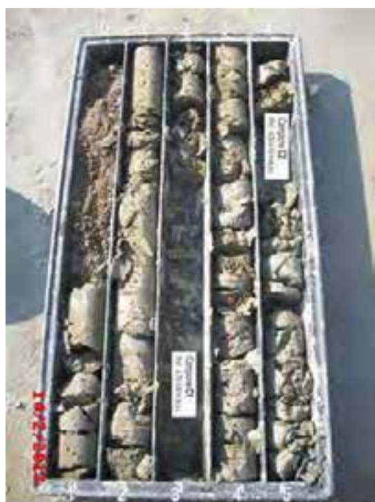
Località: Cavezzo (MO) - Porto Motta - via Eremo, 2366 Data: 14/07/2013 Sondaggio 1 Cassetta 1 (Piano Camoscio - -5.00 m da p.c.)
