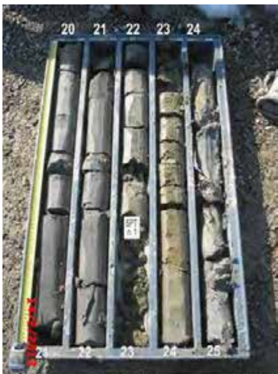
Località - Cavezzo (MO) - Ponte Molle - via Cavou, 338a Sito - 1482003 Sondaggio 1 Cassetta 5 (-20.00 m - -25.00 m da p.c.)
