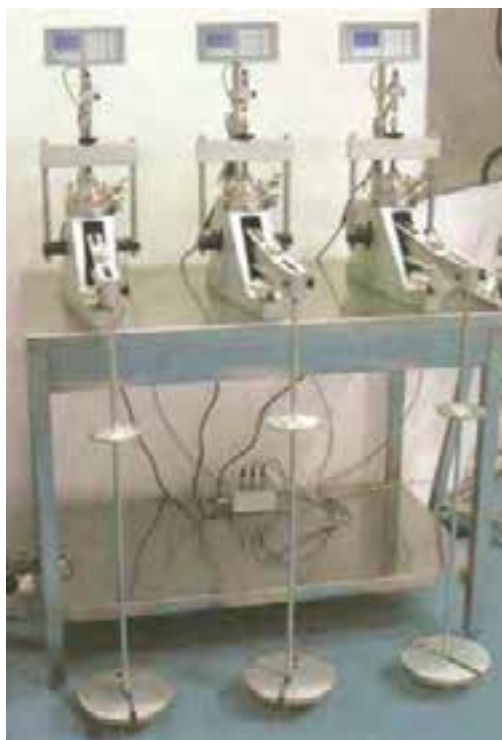
Foto n. 2.5.7.1 - Apparecchiatura per prove edometriche con edometro a fulcro fisso.
