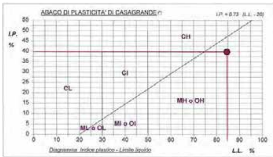
Fig. n. 2.5.4.1 - Carta di plasticità di Casagrande.
