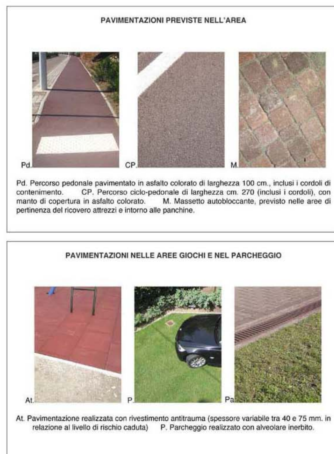
PAVIMENTAZIONI PREVISTE NELL'AREA Pd Percorso pedonale pavimentato in asfalto colorato di larghezza 100 cm, inclusi i corridoi di contenimento. CP Percorso ciclo-pedonale di larghezza cm. 270 (inclusi i corridoi), con manto di copertura in asfalto colorato. M. Massetto autobloccante, previsto nelle aree di pertinenza del roveree attrezzi e intorno alle panchine. PAVIMENTAZIONI NELLE AREE GIOCHI E NEL PARCHEGGIO Al Pavimentazione realizzata con rivestimento antitrauma (spessore variabile tra 40 e 75 mm, in relazione al livello di rischio caduta). P. Parcheggio realizzato con alveolare inerbite.
