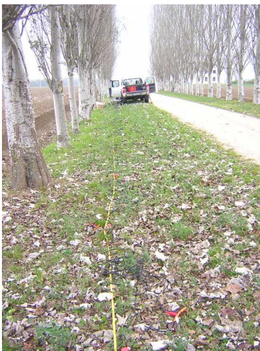
Foto n. 9.2 – Stendimento sismico a rifrazione metodo dei microtremori MASW, eseguito all’interno dell’ambito denominato “Via Matteotti”.
