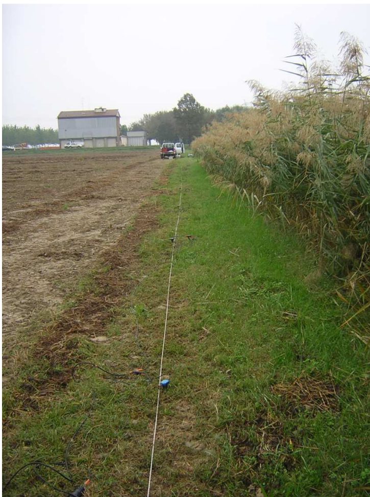
Foto n. 9.1 – Stendimento sismico a rifrazione metodo dei microtremori Re.Mi. eseguito all’interno dell’ambito SS n°12 – SP n°468.
