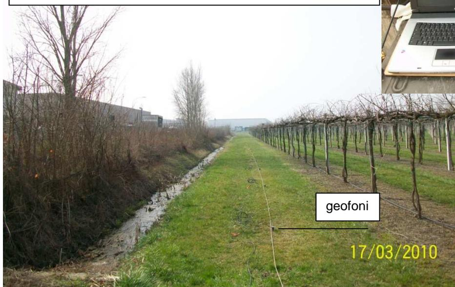
**Foto n. 9.2 – Stendimento sisimico a rifrazione metodo dei microtremori Re.Mi. eseguito all'interno dell'ambito APC.i(ni)2.**
